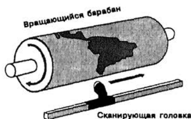
Рисунок 5.2. Принципы сканирования карты. Рисунок показывает барабанный сканер с вращающимся барабаном и перемещающимся вдоль него сканирующим устройством.
