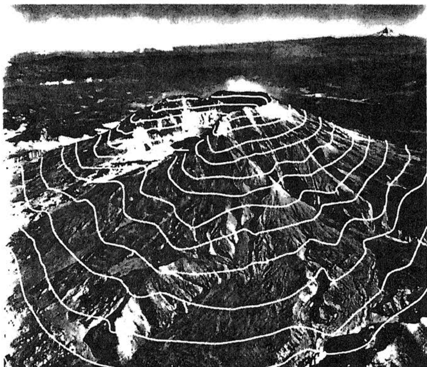
Рисунок 10.1. Перспективный вид поверхности с горизонталями. Топографическая поверхность с горизонталями, которые используются для представления ее на карте при виде сверху.
