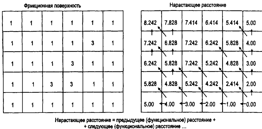
Рисунок 8.8. Нарастающее расстояние. Поверхность нарастающей стоимости: а) фрикционное покрытие, б) вычисленные значения. Отметьте, что диагональные ячейки используют значение 1.414 в качестве расстояния вместо 1 для горизонтальных и вертикальных. Выделены ячейки со значением импеданса 3. Для накопления расстояния предыдущее значение складывается с вычисленным.
