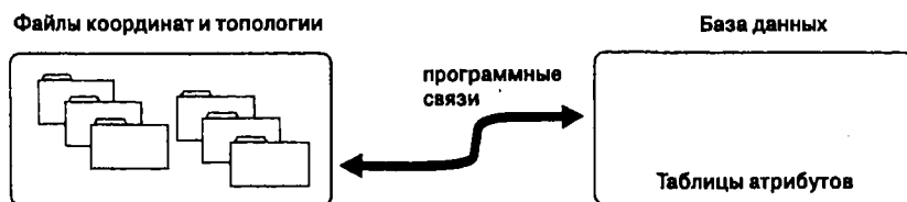
Рисунок 4.18. Гибридная векторная ГИС с хранением атрибутов во внешней БД. Файлы графических данных программно связываются с СУБД, хранящей атрибутивную информацию.
